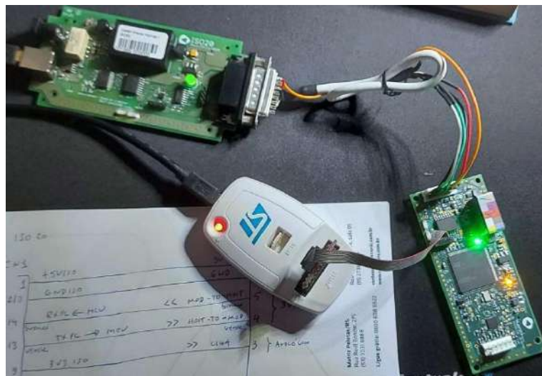
Setup de testes do módulo de ECG/VRC utilizando a interface ISO20.
