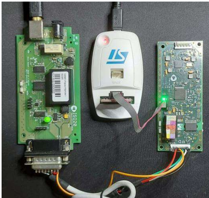
Setup de testes do módulo de SpO 2 utilizando a interface ISO20.
