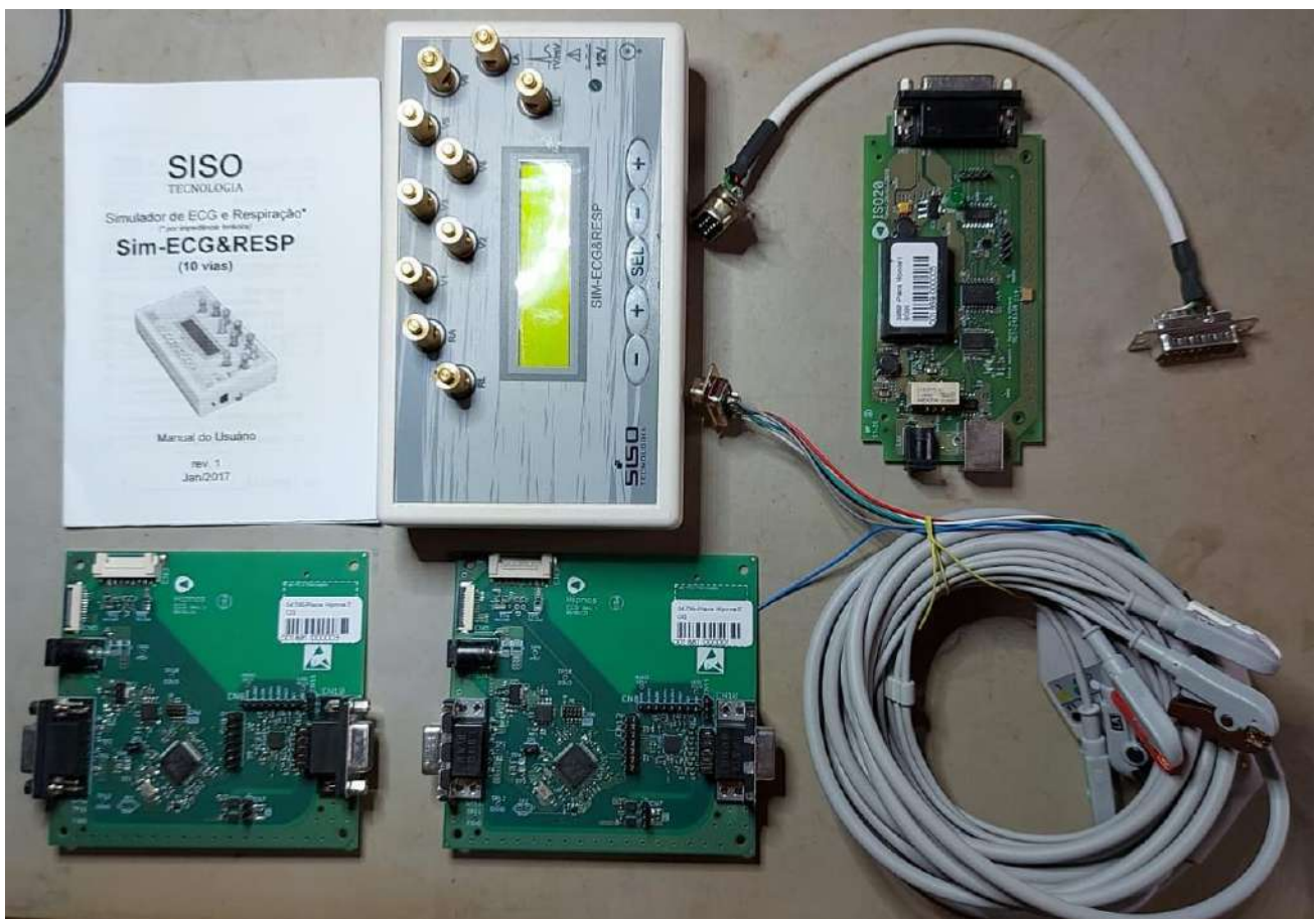
Setup usado durante o desenvolvimento: placas de ECG, placa ISO20, cabo de conexão entre placas, cabo de ECG com 5 eletrodos (7 derivações) e simulador de ECG Siso.
