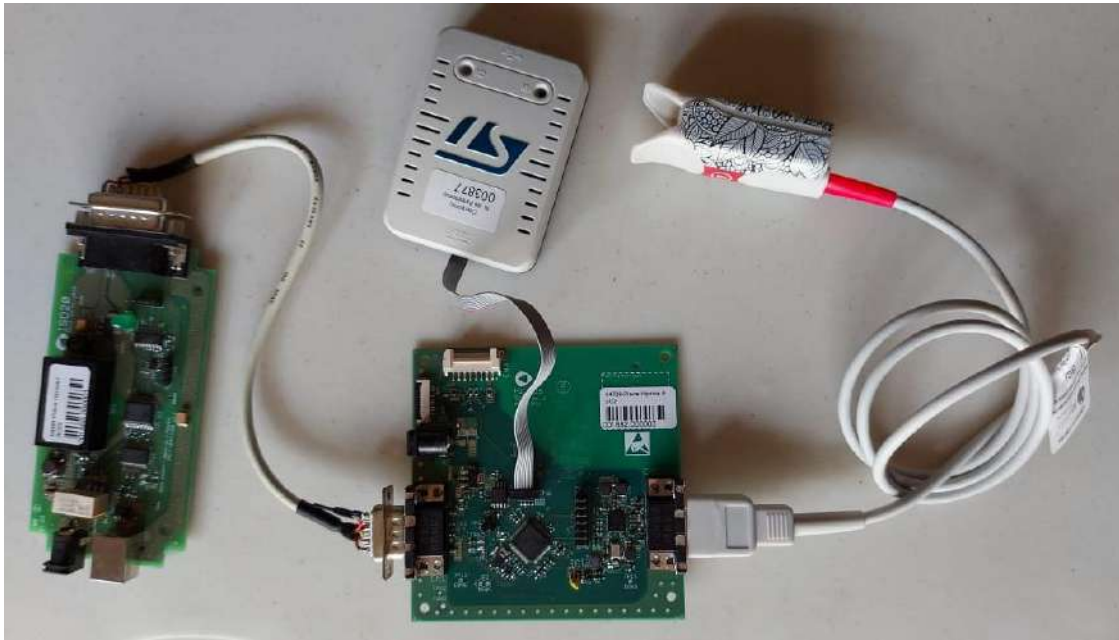
Setup básico para desenvolvimento do firmware de oximetria: placa ISO20, placa de SpO 2 Contronic, ponta e emulador ST-Link V3.
